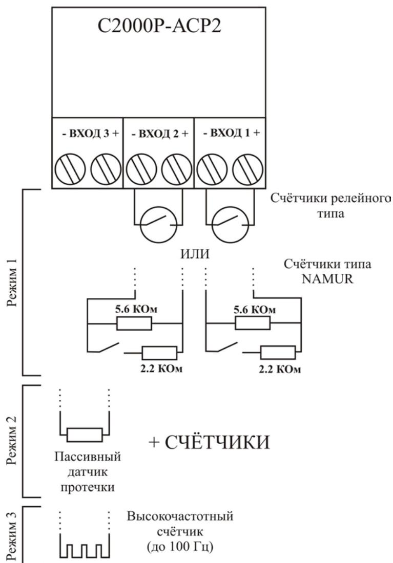
**Рисунок 11.13** Варианты подключения счётных устройств и датчиков
