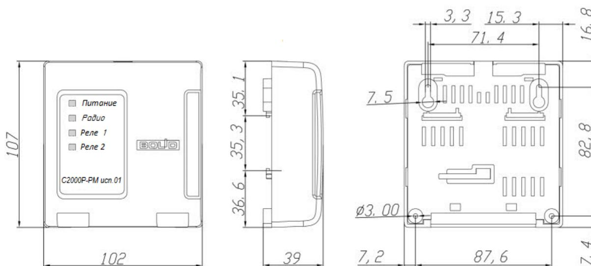
**Рисунок 11.20** Габаритные и установочные размеры С2000Р-РМ исп. 01
