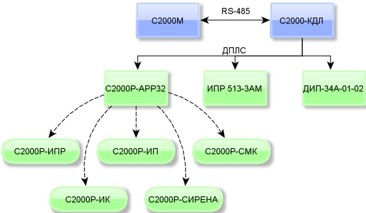
**Рисунок 1.1** Блок-схема подключения адресных радиоканальных устройств
