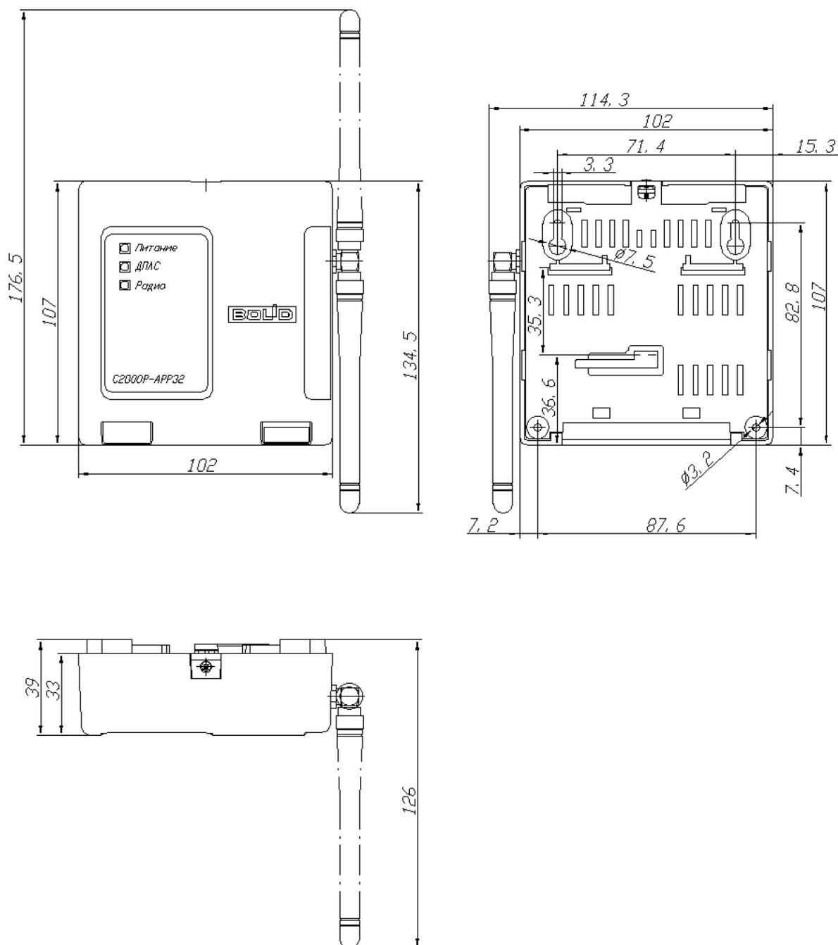
Рисунок 10.2 Габаритные и установочные размеры APP32
